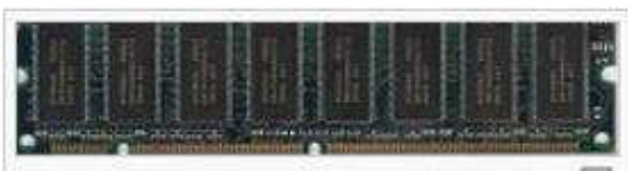
Barrette de mémoire RAM à placer sur un support SIMM. Une mémoire de 32 Mo est formée de 8 circuits mémoires de 4 Mo.
