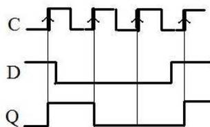
Les bascules D qui commutent sur le front montant du signal d'horloge sont dites *positive edge triggered*, il en existe d'autres qui réagissent sur le front descendant.
