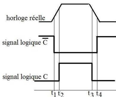
On pourra constater que pendant des laps de temps très courts,  $C$  et  $\bar{C}$ , normalement opposés, vont être égaux. Il s'ensuit les phénomènes suivants, suivant les intervalles de temps successifs :
