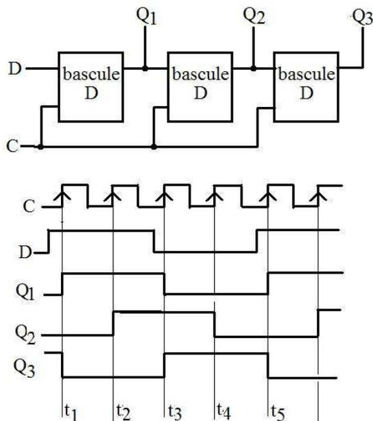
Après le premier passage à 1 de l'entrée  $D$ , la sortie  $Q_1$  passe à 1 dès le premier front montant d'horloge, à l'instant  $t_1$ , puis repasse à 0 au troisième front  $t_3$ . A son tour, la sortie  $Q_2$  de la deuxième bascule passe à 1 au deuxième front montant, à l'instant  $t_2$ , et retombe à 0 au quatrième  $t_4$ . Enfin la sortie  $Q_3$  passe à 1 à l'instant  $t_3$ , tout cela se répétant ensuite de façon cyclique.
