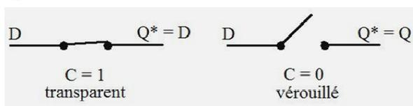
Remarquons que le cas interdit  $S = R = 1$  du verrou SR ne se produit plus dans le verrou  $D$ . Voici un exemple d'évolution dans le temps, où l'on suppose que  $Q$  est à 0 au départ :
