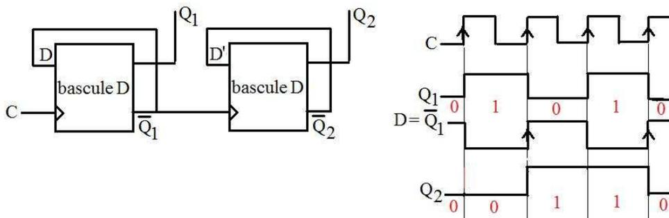
Finalement les deux sorties  $Q_2$   $Q_1$  prennent les valeurs 00, 01, 10, 11, et cela de façon répétée. Le circuit se comporte comme un compteur modulo 4. Cela se généralise. En plaçant  $n$  bascules D en cascade, on obtient un compteur modulo  $2^n$ . Un tel circuit est asynchrone, car s'il est synchronisé sur les impulsions de l'horloge pour la première bascule D, il ne l'est plus dans les suivantes, et de légers décalages en cascade peuvent finir par perturber le comptage.
