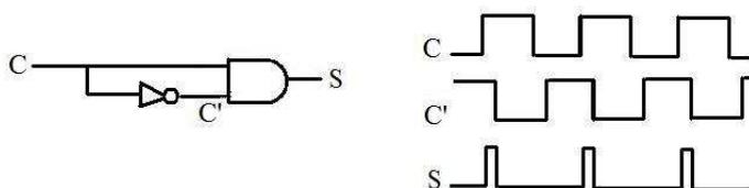
En introduisant une nouvelle dérivation dans ce signal à impulsions, avec un temps de retard plus important, on peut obtenir deux signaux décalés d'un demi-cycle d'horloge l'un par rapport à l'autre. Cela permet de gérer certains évènements deux fois plus rapidement, par rapport au cycle d'horloge initial.
