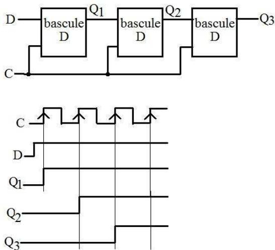
**Exercice :** Prendre comme précédemment trois bascules D en succession, et soumettons l'entrée  $D$  à un signal périodique, avec une période double de celle de l'horloge  $C$ . Les trois sorties des bascules sont aussi reliées à des lampes  $L_1$ ,  $L_2$ ,  $L_3$  qui s'allument si la sortie vaut 1 et s'éteignent à 0. Que va-t-il se produire ?
