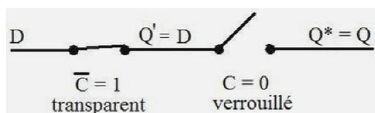
Finalement, la valeur de l'entrée  $D$  n'est prise en compte que lors du front montant de l'horloge, et elle est transférée dans la sortie  $Q$ . Le basculement n'est possible qu'à ce moment-là. Entre deux fronts montants de l'horloge, la sortie  $Q$  ne change pas.
