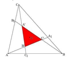
Considérons un triangle ABC de sens direct, avec les points  $A_1$ ,  $B_1$ ,  $C_1$  situés respectivement au tiers des côtés [BC], [CA], [AB] à partir des points B, C et A. Les droites  $(AA_1)$  et  $(BB_1)$  se coupent en un point C, les droites  $(BB_1)$  et  $(CC_1)$  se coupent en A,  $(CC_1)$  et  $(AA_1)$  se coupent en B. C'est ainsi que l'on obtient le triangle A'B'C' à partir de ABC.
