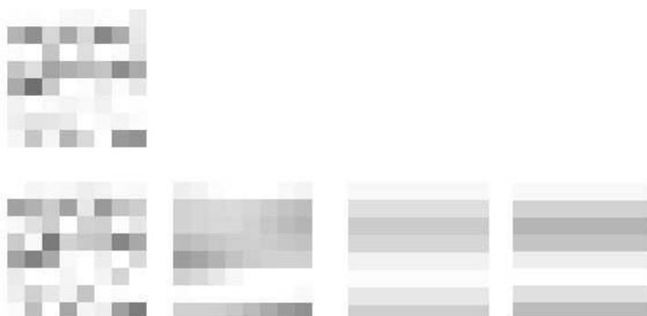
Figure 14 : un bloc 8x8 de l'image, en haut à l'origine, et au-dessous dans l'image reconstruite avec  $Q$ ,  $5Q$ ,  $10Q$  et  $15Q$ . Malgré des changements prononcés pour  $5Q$  et  $10Q$ , les répercussions sur l'image globale sont peu visibles. Elles ne sont vraiment importantes que pour  $15Q$
